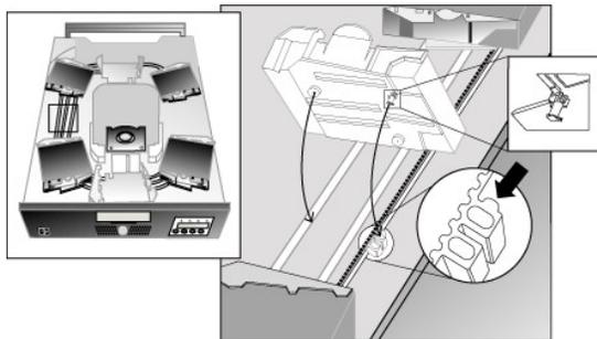
13. カートリッジキャリヤの底面にあるベグをベルトのスロットに挿入し、カートリッジキャリヤをゆっくり回してベルトに固定します。
