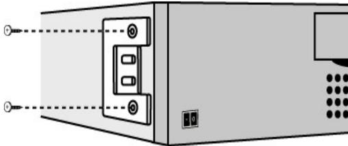
5. オートローダがラックに設置されていて取り付けブラケットがある場合は、オートローダの背面にある 5 本のネジと、両側面に 1 本ずつあるネジを外し、カバーを緩めます。机上に設置されている場合は、前面カバーのネジと、両側面に 3 本ずつあるネジを外します。
