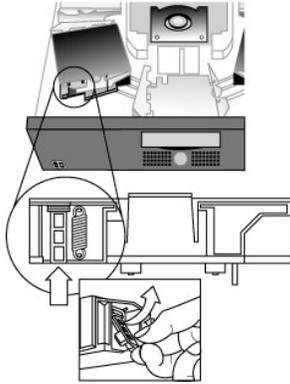
10. 目的のキャリヤからカートリッジを取り出したら、それぞれのキャリヤをオートローダベルトに再度取り付けます(「[キャリヤの取り付け](#)」を参照してください)。
